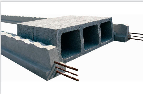
Rectobeton – wypełnienie pustaki z czystego betonu. Wysokość całkowita stropu [cm]: od 16 do 33. Masa: 1 m 2 stropu od 235 kg. Klasyfikacja ogniowa: od REI30 do REI240 (do REI60 możliwa wersja beztylnkowa). Stosowane we wszystkich rodzajach budynków, na wszystkich kondygnacjach uzupełnieniem systemu są: zbrojenia przypodporowe, zgrzewane maty siatki stalowej oraz beton monolityczny wylewany na budowie.
