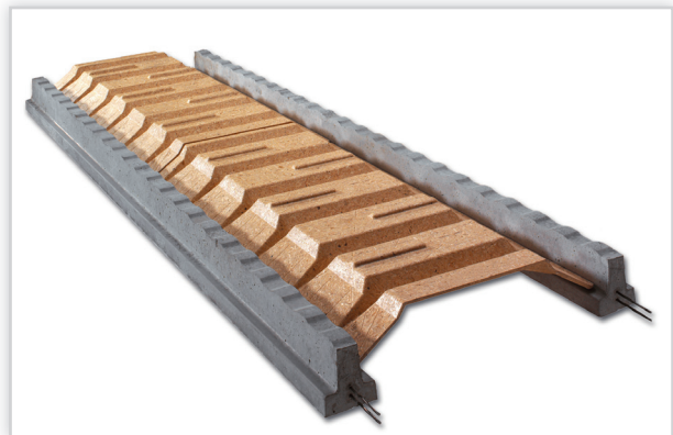
Rectolight. Wypełnienie: panele stropowe z drewna prasowanego. Długość elementu: 120 cm, zastępuje 6 pustaków. Wysokość stropu [cm]: od 16 do 26. Masa: 1 m 2 stropu od 190 kg. Klasyfikacja ogniowa: do REI60 (REI120 przy zastosowaniu sufitu odwieszanego w klasie EI120). Stosowane we wszelkich budynkach mieszkalnych i użyteczności publicznej, z zastosowaniem sufitów podwieszanych. Uzyskiwane rozpiętości w systemie Rectolight wahają się między 1,8 m do ponad 8,0 m. Łatwość w cięciu i wykonywaniu otworów sprawia, iż jest dopasowany do każdego projektu. Konstrukcja stropu może uzyskać ognioodporność REI 60 (Badanie ITB nr 649/17/ZOONZP).
